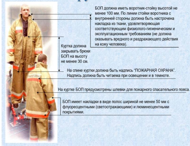
Рис.46 Конструкция БОП
